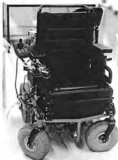
Fauteuil électrique à double télécommande (ici en réparation), bénéficiant des progrès de la robotique et actuellement utilisé à l'hôpital de Garches
